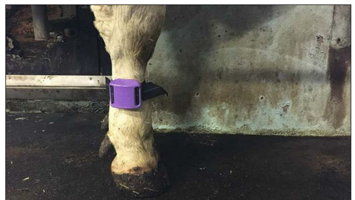
Bein-Transponder für präzise Aktivitätsmessung.
